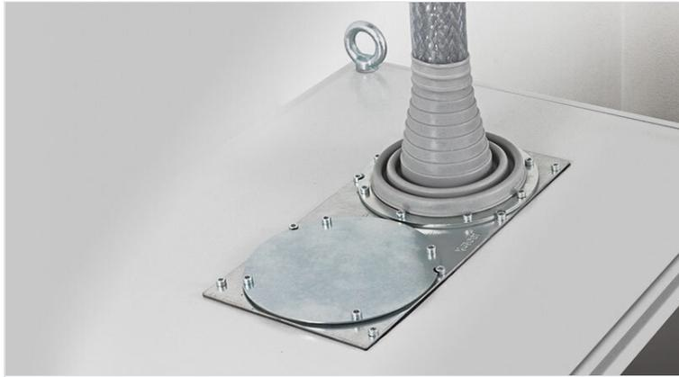
KEL-ULTRA flexシリーズは、外径25～115mmの非常に太く硬いケーブルやコンジットを挿入できるよう開発されました。ピラミッド型の柔軟性の高いデザインにより、従来のケーブルグラウンドに比べて、ケーブルの挿入と位置決めが非常に簡単です。
